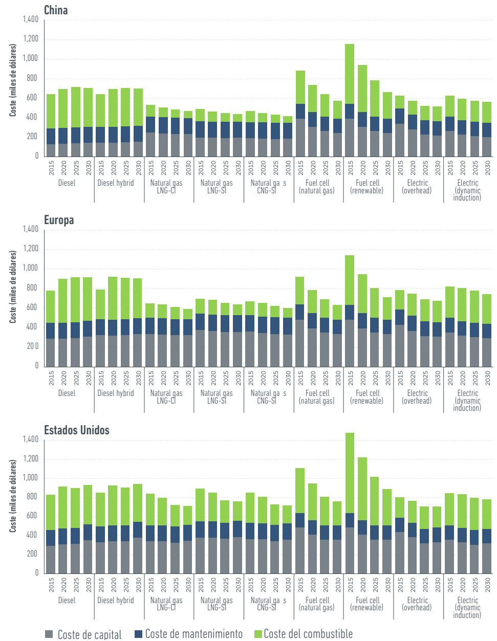
Fig 42. Costo total de propiedad de un camión de acarreo promedio respecto a distintas fuentes de energía, características de los vehículos y si es con o sin subsidios. Adaptado de: Leung y Peace (2020).
